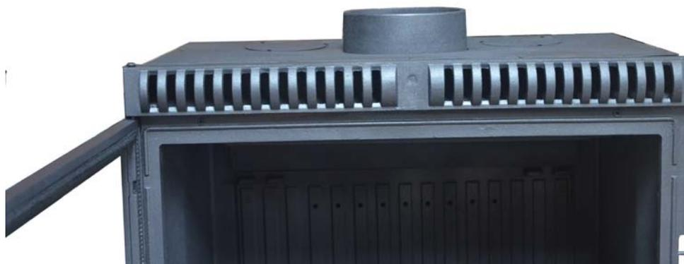
La entrada del aire secundario, se encuentra en la parte superior de la puerta, entre el cristal y la puerta de fundición que permite un mayor tránsito de aire impidiendo la acumulación de carbono y por consiguiente la suciedad del cristal. El cristal, incluye un cordón cerámico resistente a altas temperaturas, para favorecer el sellado de la cámara de combustión y así aumentar el rendimiento.
